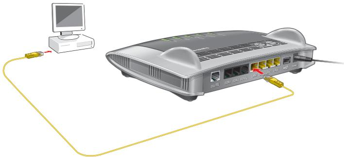
Collegamento di un computer con un cavo di rete
